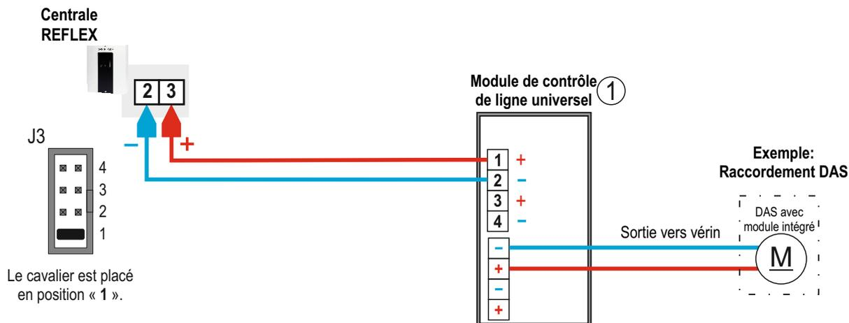
**EXEMPLE DE RACCORDEMENT EN SERIE**
