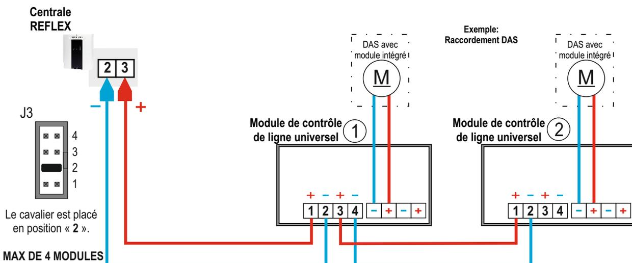
**EXEMPLE DE RACCORDEMENT EN ETOILE**
