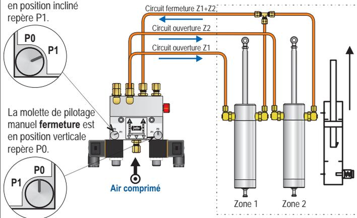
La molette de pilotage manuel **fermeture** est en position incliné repère P1.
