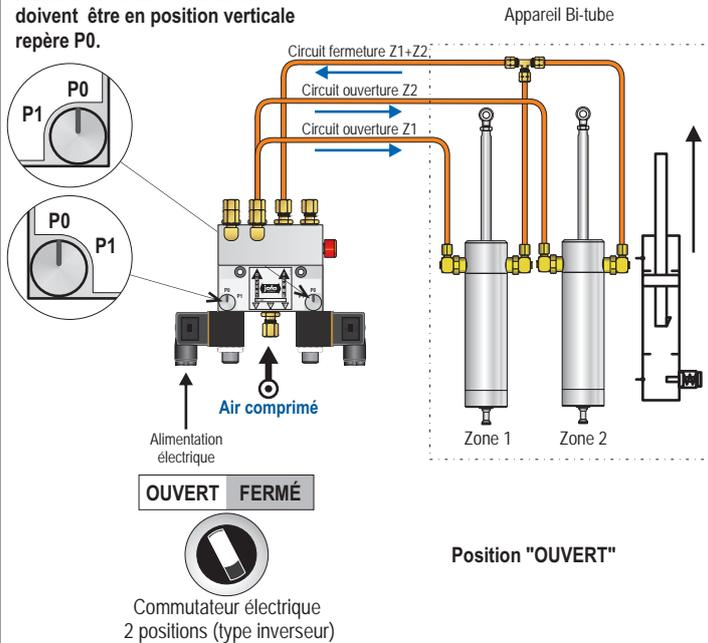
**Les molettes de pilotage manuel ouverture et fermeture doivent être en position verticale repère P0.**
