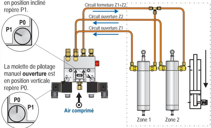
**Les déclencheurs du bloc aération ne sont pas alimentés électriquement**
