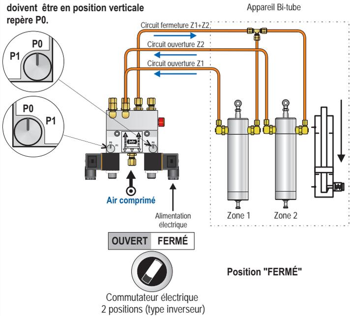
**UTILISATION DU PILOTAGE MANUEL (bloc non alimenté en électrique)**
