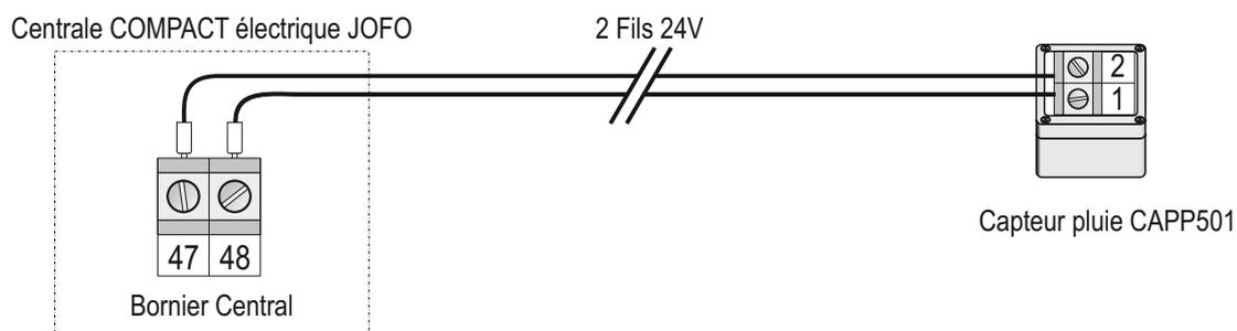
**CÂBLAGE DU CAPTEUR PLUIE SUR LA CENTRALE ELECTRIQUE JOFO**
